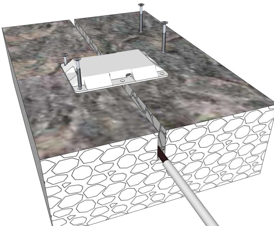
En casos que requiera una base más sólida debido a la deformación del pavimento se dispone de bloques de hormigón que se encastran impidiendo que el suelo ceda:
